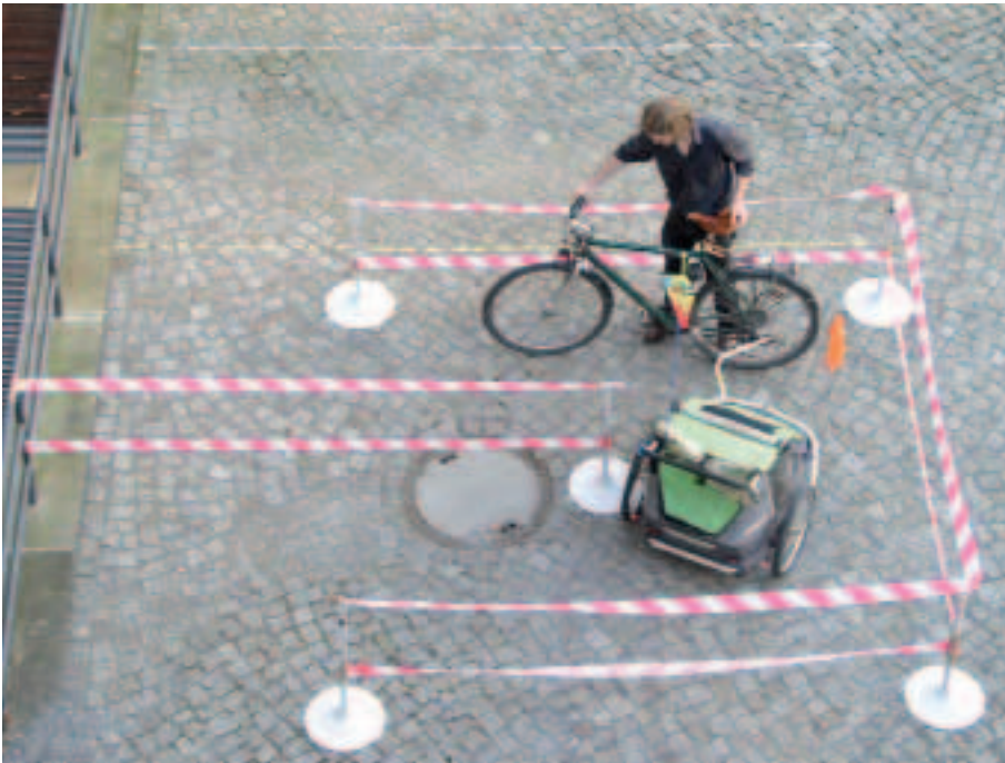
Abb. 4: Versuchsaufbau zur Nutzbarkeit von Umlaufsperrn
