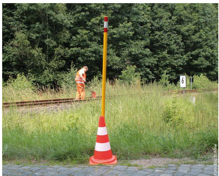
Abbildung 6: Bei der Vermessung wird die Sichtbeziehung vom Gleis zu den Markierungsstangen an der Straße geprüft
