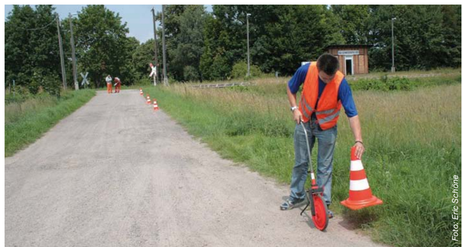
Abbildung 6: Bei der Vermessung wird die Sichtbeziehung vom Gleis zu den Markierungsstangen an der Straße geprüft
