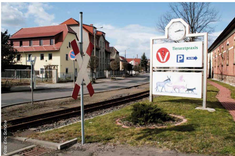
Abbildung 4: Durch die Werbetafel wird die Sicht auf die Bahnstrecke vollständig verdeckt
