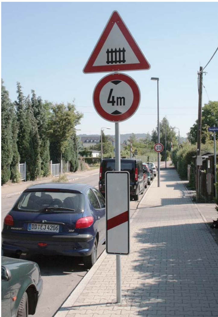
Abbildung 2: Die Ankündigung erfolgt nur durch Gefahrzeichen mit einstreifiger Bake und ist somit unvollständig. Außerdem kann die Bake durch parkende Fahrzeuge verdeckt und damit wirkungslos werden, Foto: Schöne.
