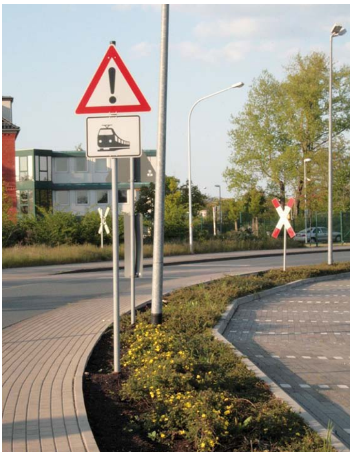
Abbildung 6: Regelwidrige Verwendung des Zeichens 101 „Gefahrstelle“ vor einem Bahnübergang mit Vorrang, erkennbar an den Andreaskreuzen. Richtig wäre hier das Zeichen 151 „unbeschränkter Bahnübergang“ gewesen, Foto: Schöne.
