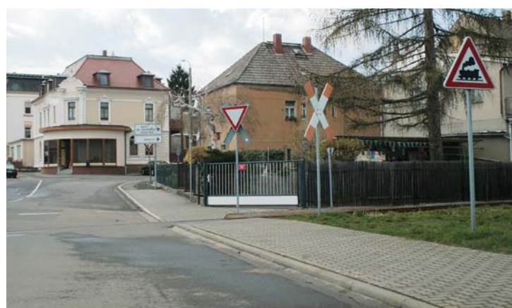
Abbildung 4: Das Gefahrzeichen befindet sich in deutlich zu geringer Entfernung vor dem Bahnübergang. An dieser Stelle muss ein Straßenverkehrsteilnehmer nicht nur den Bahnübergang wahrgenommen, sondern bereits auf sich nähernde Schienenfahrzeuge geachtet haben, Foto: Schöne.
