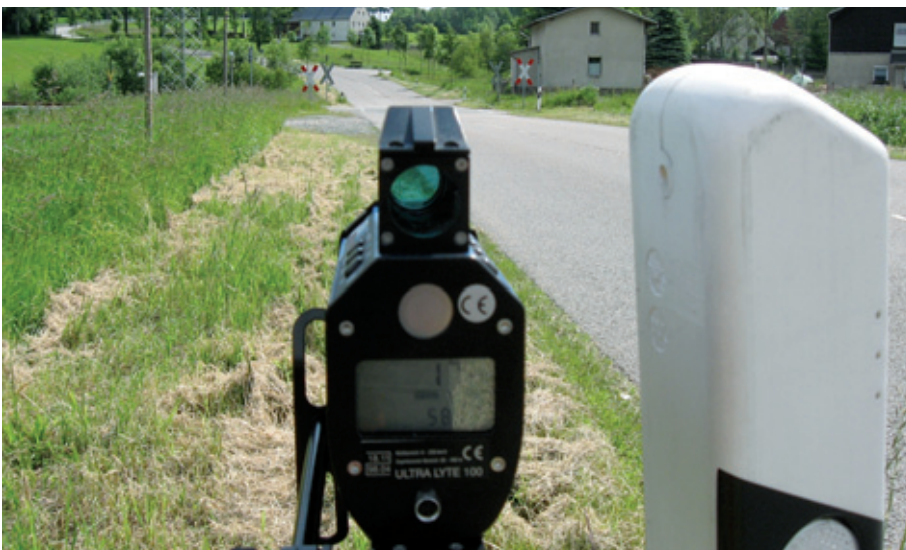
Abb. 5: Aufstellung der Laserpistole
