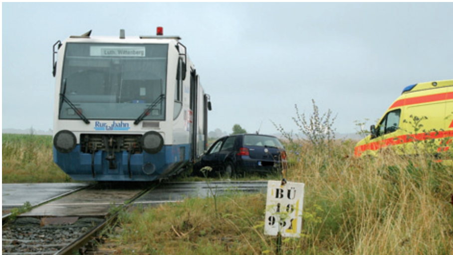
Abb. 1: Zusammenprall an einem nichttechnisch gesicherten BÜ
